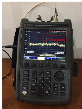
Gambar 10. Pengukuran level penerimaan sinyal
